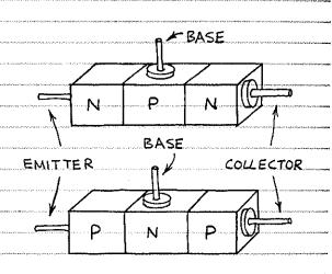
BIPOLAR TRANSISTOR OPERATION— THE THREE LAYERS OF A
